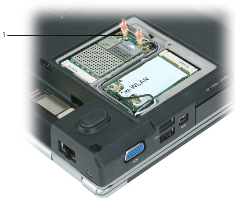
1 разъемы антенных кабелей (2)
