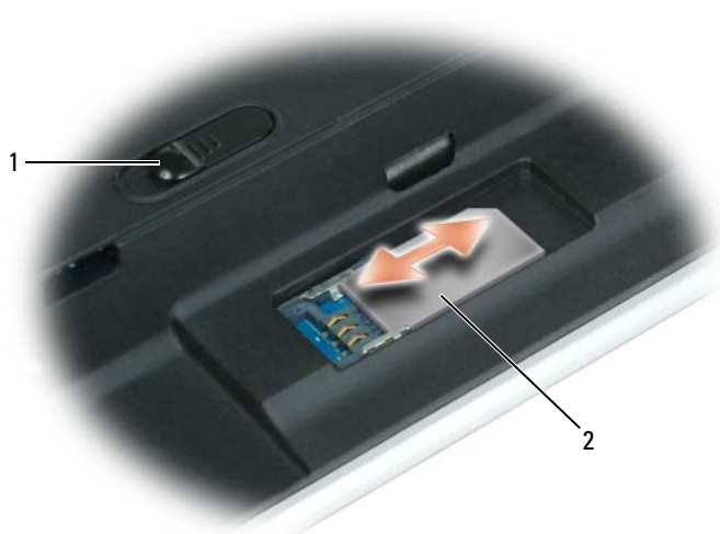
1 защелка аккумуляторного отсека 2 SIM-карта
