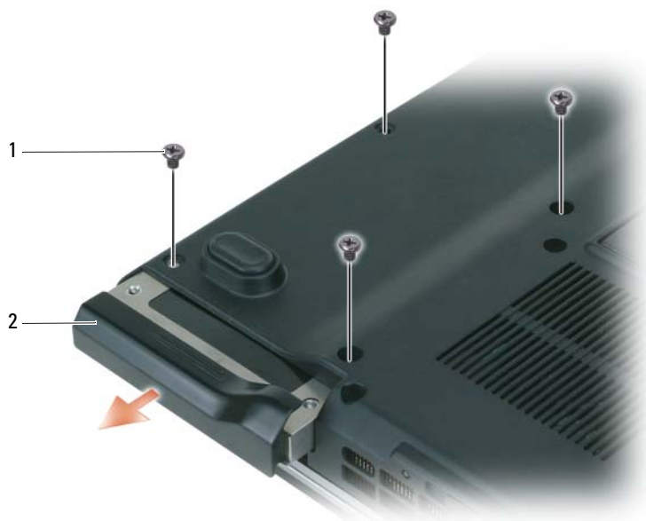
1 винты жесткого диска (4) 2 жесткий диск
